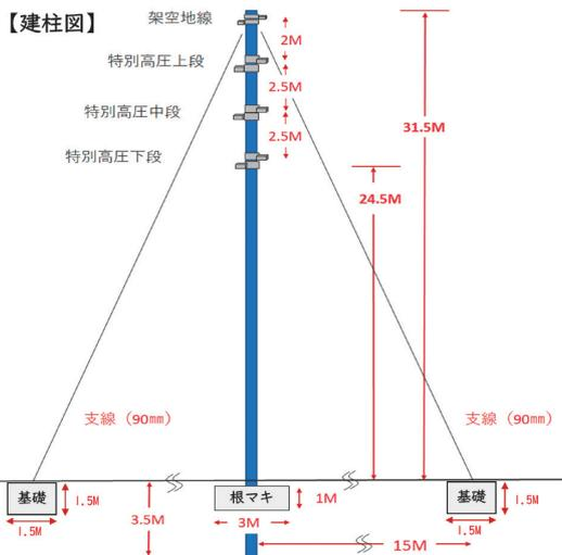
環境や景観への影響を配慮し、メガソーラー事業の送電計画を変更しました。当初は全て鉄塔を使った送電を計画していましたが、通常より高めの電柱を使用し、一部は道路に埋設する形にします。
